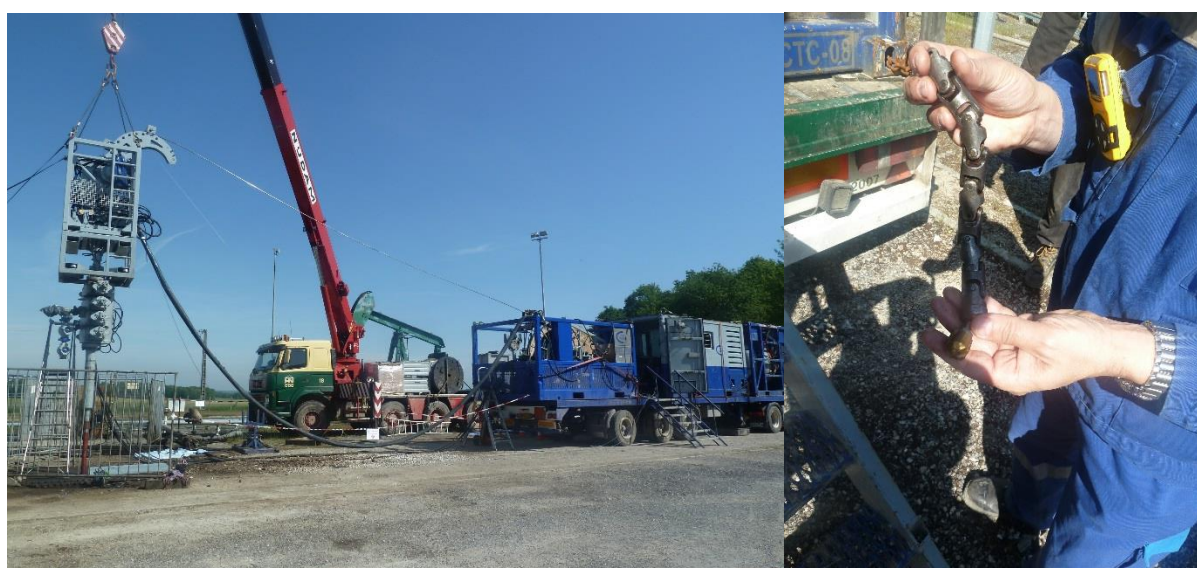
Figure 40 – Mise en œuvre du procédé Raddial Drilling pour la production d'huile à partir du Dogger dans le bassin parisien (opération Lundin 2013)
