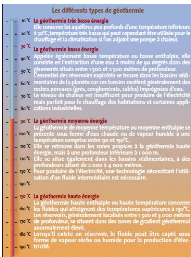
Figure 6 – Les différents types de géothermie (source : ADEME)
